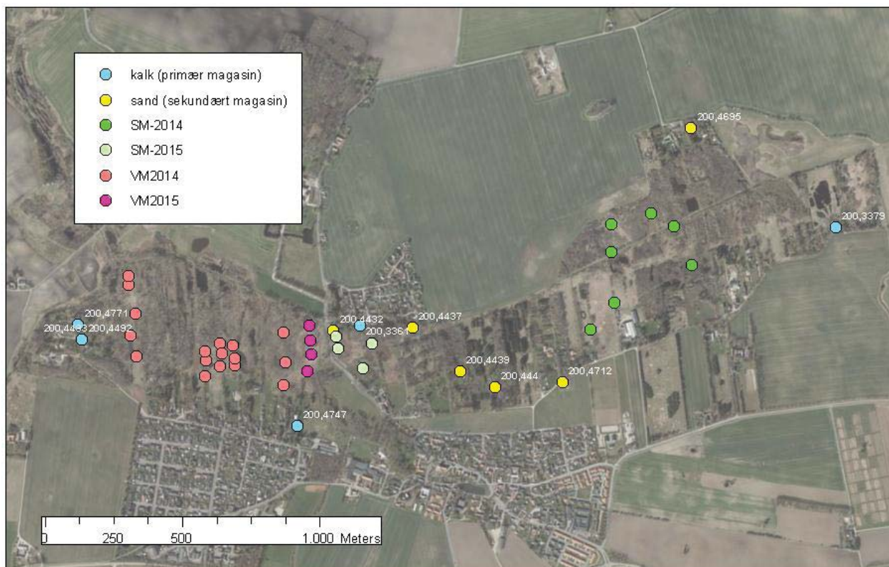
Figur 7. Samtlige dybe borer der indgår i de store pejlerunder i de tilgrænsende grundvandsmagasiner i kalk og smeltevandssand, samt grupper af pejlerør der er etableret i den øvre del af moseaflejringerne i de to moser i henholdsvis 2014 og 2015. Hver prik med symbol 'SM-2014', 'SM-2015', 'VM-2014' og 'VM-2015' repræsenterer en rede af to til tre pejlerør med kort filtre placeret i dybder fra 1 til 3,5 meters dybde.
